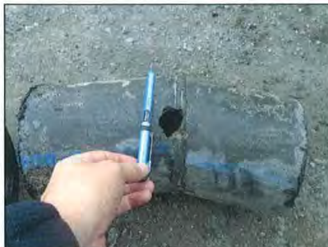
Figura 3. Imagen de Fisura en Tubería de Transporte de Relave.
